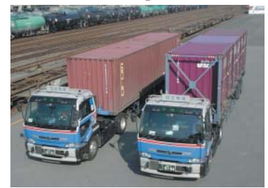
ラックの開発で、海上コンテナと鉄道コンテナの両方を輸送できる車両になりました。
