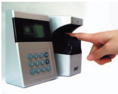
指の静脈の形状を読みとる認証方式により、より高いセキュリティを実現します。
