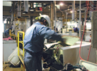
洗濯機の手解体
