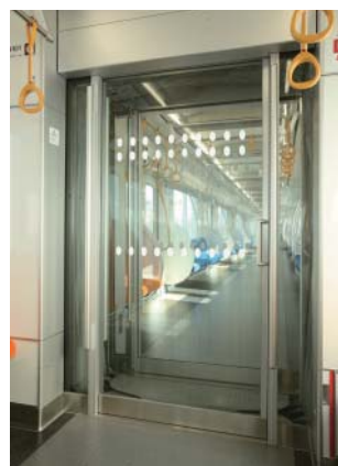
車端部に見通しのよい大型ガラスを採用した西武鉄道30000系車両
