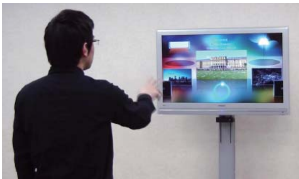
手のジェスチャーのみでテレビの基本操作を行うことができるユーザーインターフェース
