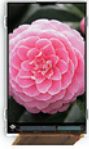
日立ディスプレイズの 携帯電話用2.9型 ワイド高精細(WVGA) IPS液晶ディスプレイ
